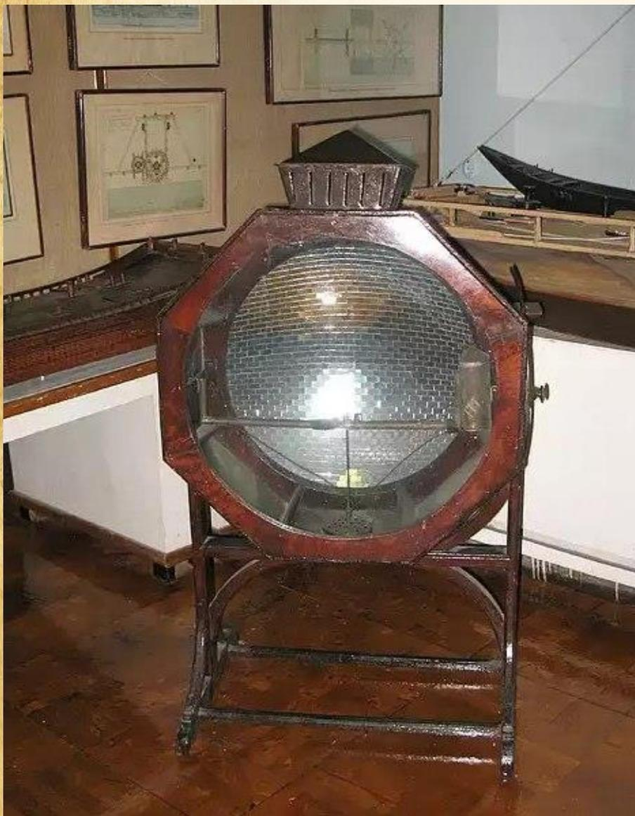
В 18 веке не было ярких источников света, но Кулибин смог сконструировать прожектор с такой системой зеркал, что свет обычной свечи, многократно отражаясь, давал узконаправленный яркий луч.
